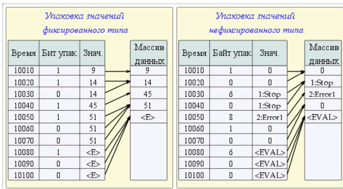
Рис. 5. Механизм последовательной упаковки значений.
